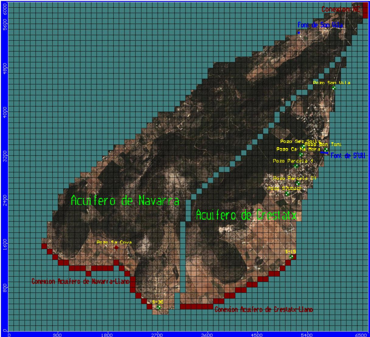
Figura 6. Límites abiertos del modelo y acciones sobre el sistema
